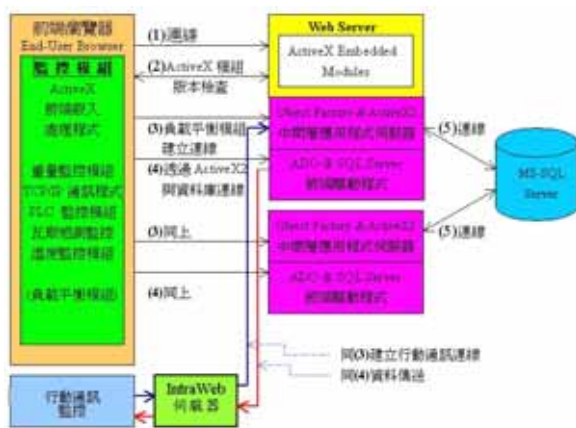
圖一 負載平衡式網路監控系統架構
