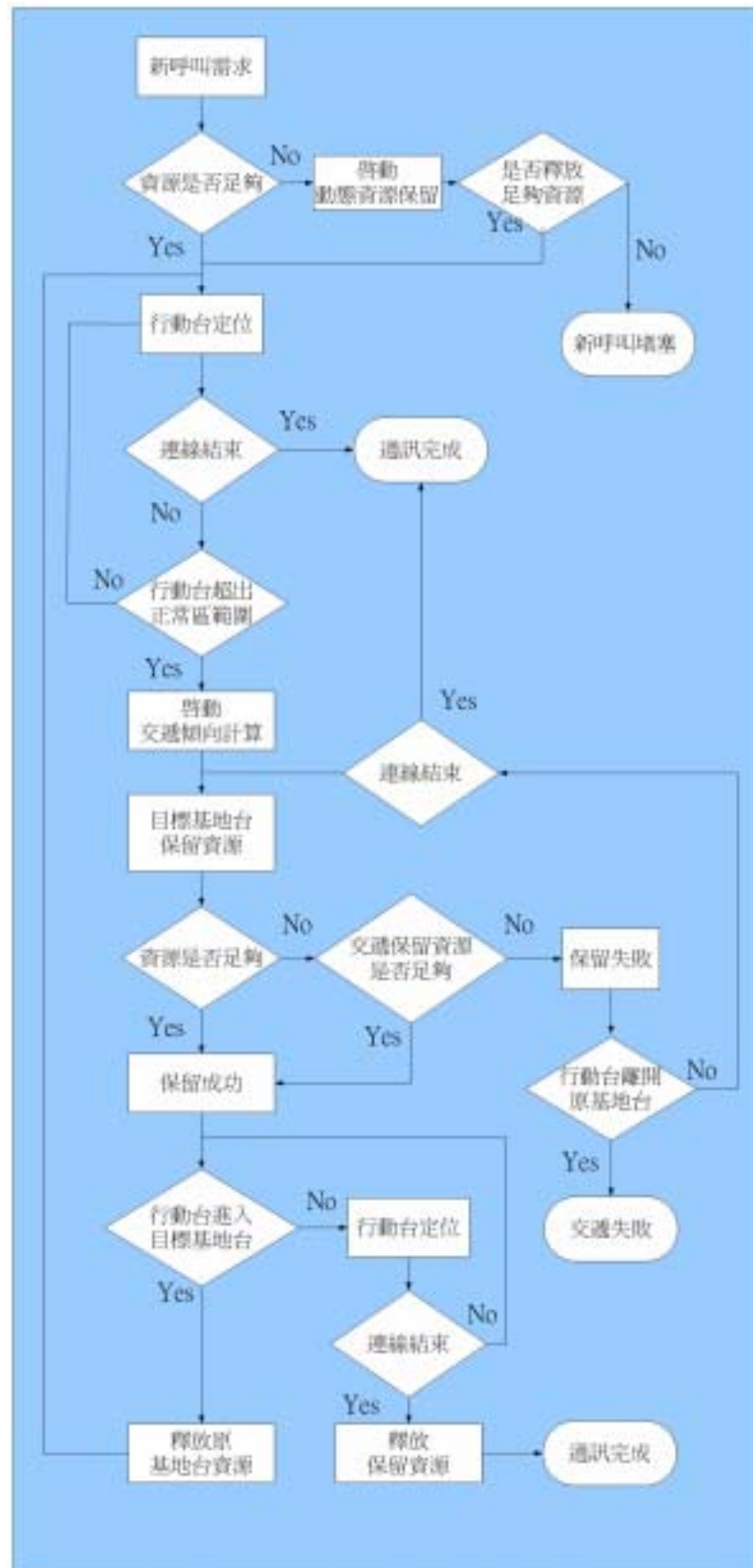
圖 3.11：行動台與基地台連線的流程
