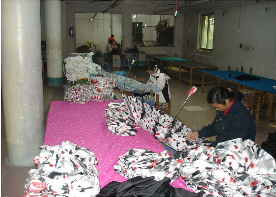
「金日」製傘工序流程之一——扣縫
